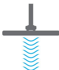
Čelní pohled na nejsilnější profil signálu Double-D.
