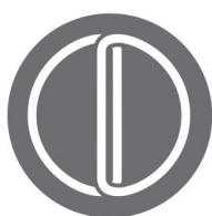
Nejsilnější signál je tam, kde se vinutí Tx a Rx překrývají.
